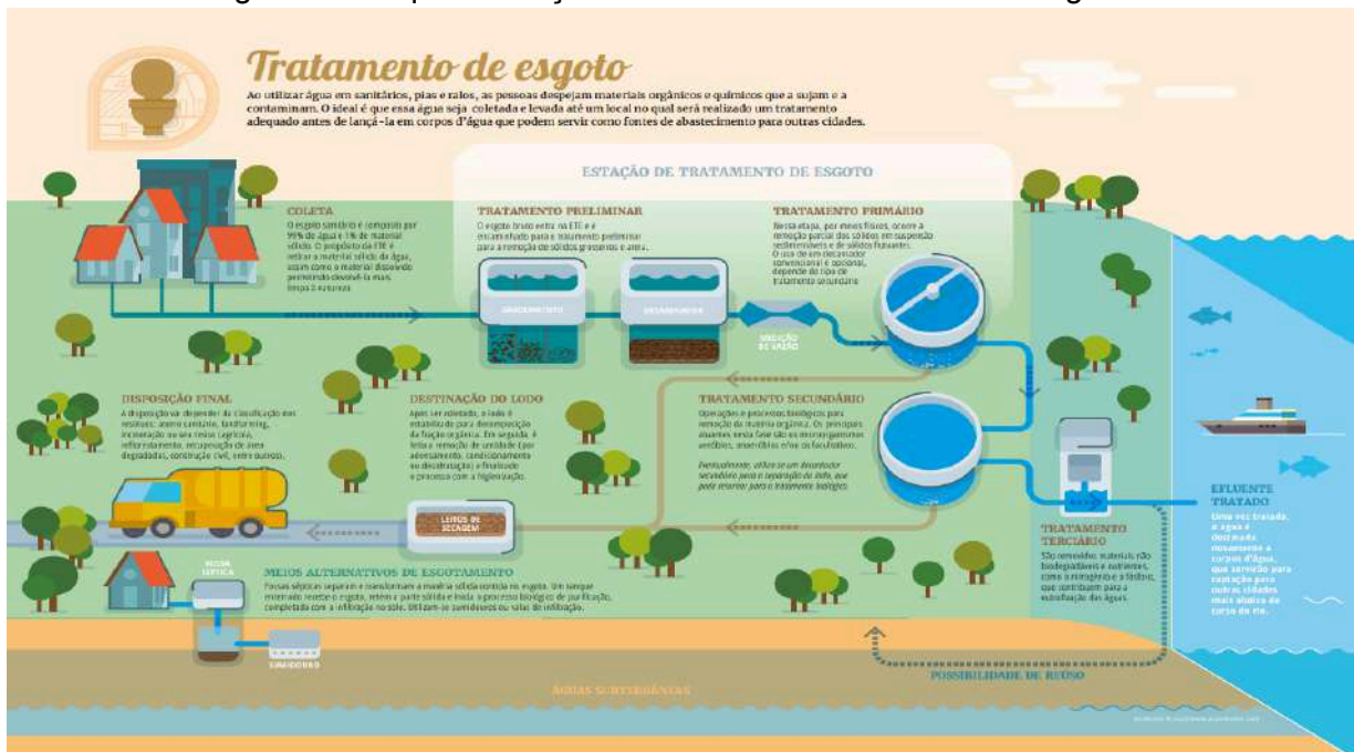
Figura 31: Esquemática do sistema de tratamento de esgoto.
