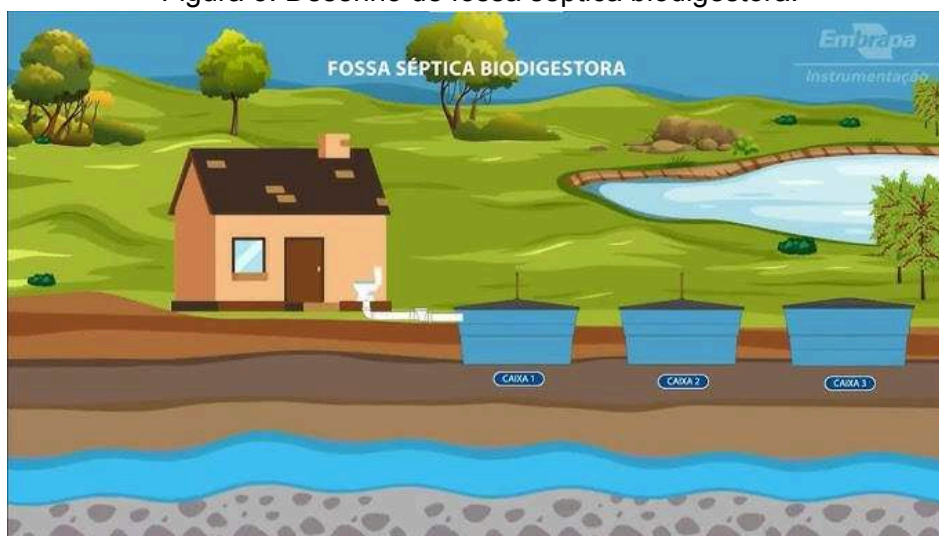
Figura 3: Desenho de fossa séptica biodigestora.
